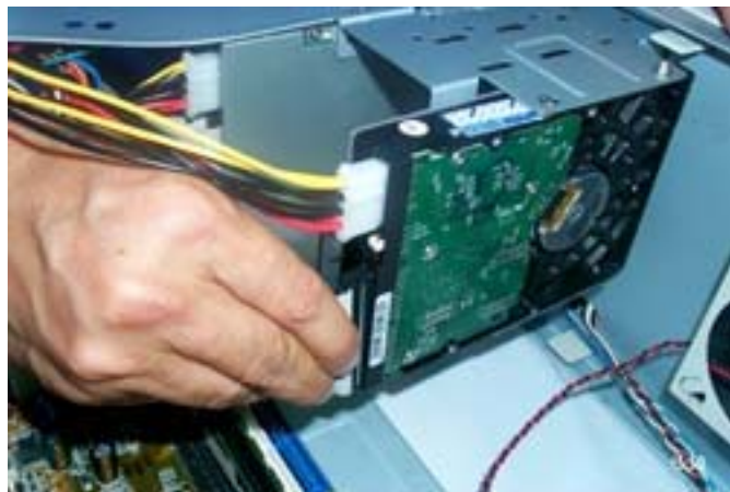
การเชื่อมต่อฮาร์ดดิสก์เข้ากับระบบคอมพิวเตอร์ โดยมีสายส่งสัญญาณ IDE เป็นสื่อกลางเชื่อมฮาร์ดดิสก์กับเมนบอร์ด
