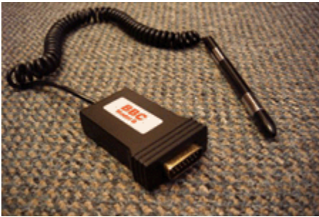
(ก) ปากกาแสง ปลายด้านหนึ่งมีสายเชื่อมไปต่อกับคอมพิวเตอร์
